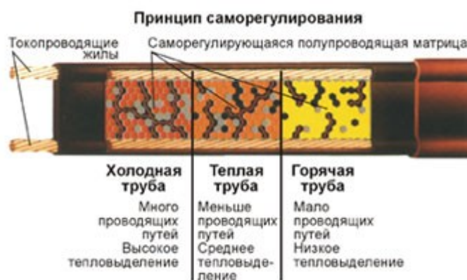
Рис.4. Принцип работы саморегулирующейся тепловыделяющей матрицы.
